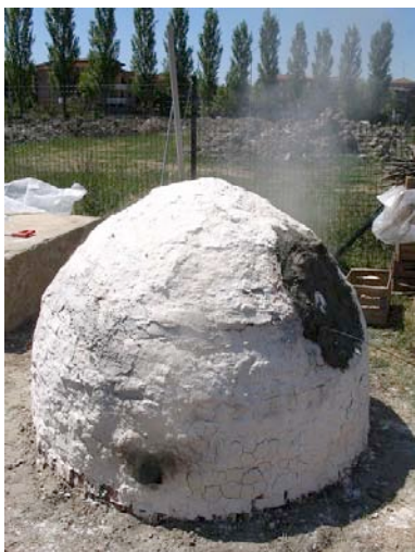
Fig. 2 Un'immagine della fornace a legna durante la fusione sperimentale.
