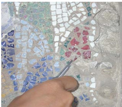
Fig. 1 Il prelievo di una tessera dal ninfeo della Casa del Centenario a Pompei: i materiali campionati vengono caratterizzati in laboratorio.
