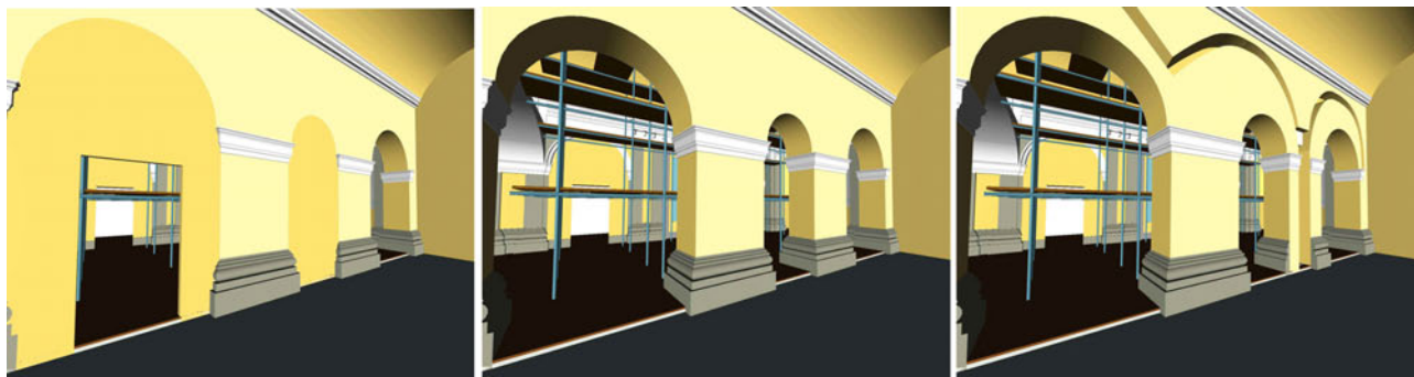
Fig.1 Immagini del modello, relative alla fase di rimozione dei tramezzi che dividevano la navata centrale da quella di destra e alla messa in luce della colonna e delle arcate individuate grazie alle indagini endoscopiche.
